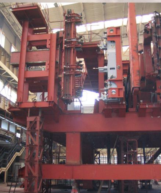
Montaža koksne baterije u Goši FOM Smederevska Palanka za železaru Krivi Rog, RUSIJA
